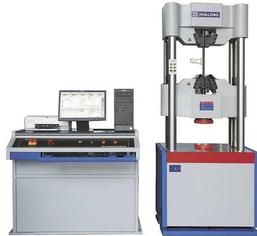
Prensa Universal para ensayos mecánicos con dinamómetro digital y graficador computarizado.
