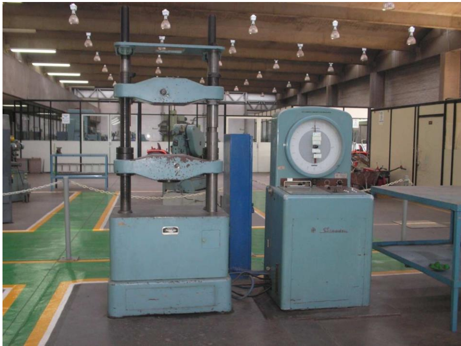
Prensa Universal para ensayos mecánicos con dinamómetro analógico.
