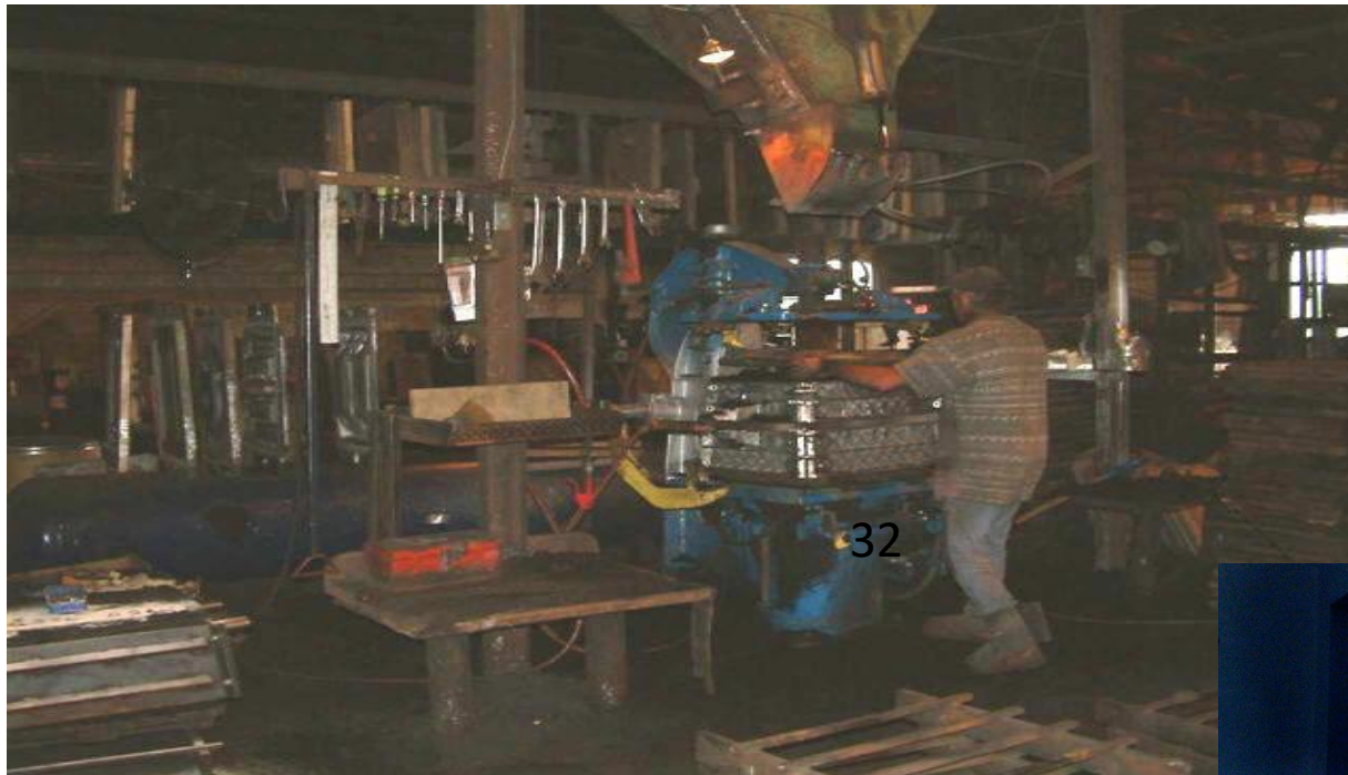
FIGURA 2.18 Moldeo en verde con moldeadoras neumáticas
