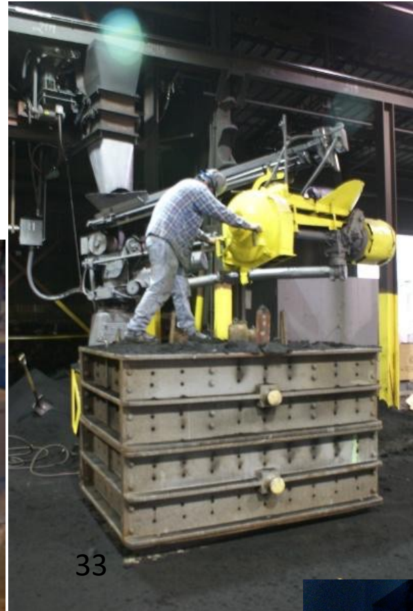
FIGURA 2.19 Moldeo con arena en verde de piezas de grandes dimensiones
