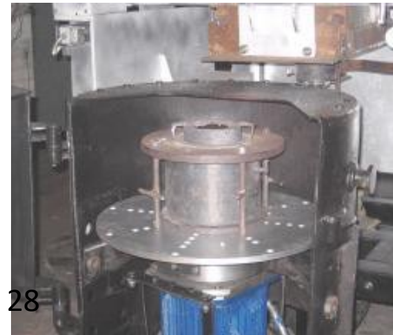
(a) (b) FIGURA 2.14 Centrifugado. (a) Descripción esquemática para centrifugado en eje horizontal (b) Máquina para centrifugado vertical
