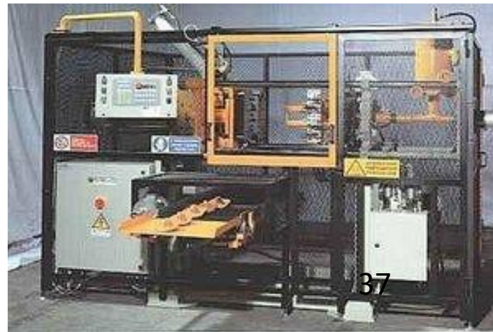
FIGURA 2.22 Máquina sopladora de corazones de caja caliente
