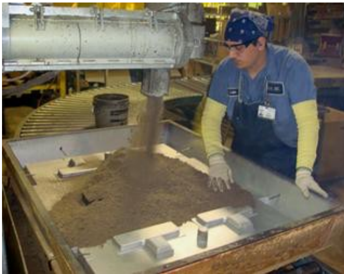
FIGURA 2.19 Moldeo con arena en verde de piezas de grandes dimensiones
